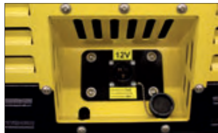
Розетка для зарядного тока BEOS Комплект деталей для сохранения заряда аккумулятора посредством розетки для зарядного тока. 3-штифтовая фланцевая муфта, температурный датчик для контроля аккумулятора. Используется исключительно с зарядным устройством BEOS.
