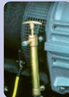
Ручной насос отсоса масла для быстрой и простой замены масла.
